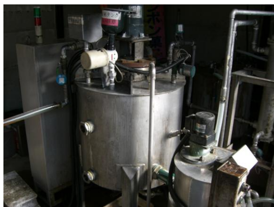
[写真] 廃食用油のリサイクル施設（バイオディーゼル燃料処理槽）
