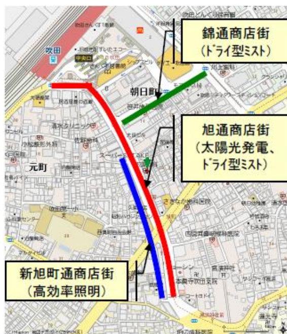
〔図〕 JR 吹田駅前商店街（3 商店街）のエコ化設備の設置状況①
